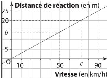
**b.** À une vitesse de 50 km/h, on lit sur le graphique une distance de réaction  $b \approx 14$  m.
