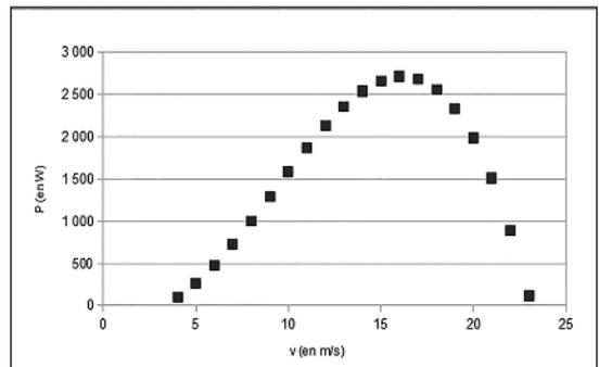
**d.** En utilisant le graphique et le tableau, on peut dire que la puissance développée par l'éolienne est maximale lorsque la vitesse du vent est environ 16 m/s.
