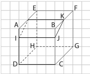
Cette section est obtenue par un plan parallèle à l'arête [AB] (ou [DC] ou [HG] ou [FE]) mais non à une face.
