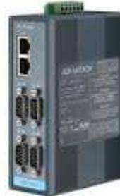
*Elle permet de convertir les couches physiques Ethernet / RS485, et d'encapsuler / Désencapsuler les trames entre les protocoles Modbus RTU et Modbus TCP.*
