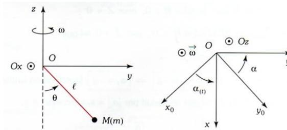
1) Un moteur permet d'imposer une vitesse angulaire constante  $\omega_0$  de rotation du référentiel R autour de Oz. Quelle est la valeur de l'angle  $\theta_e$  correspondant à l'équilibre du pendule dans le référentiel tournant R ?
