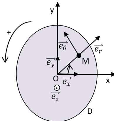
L'étude du mouvement guidé de M peut s'effectuer dans deux référentiels : le référentiel terrestre  $R(O, \vec{e}_x, \vec{e}_y, \vec{e}_z)$  ou le référentiel du disque  $R(O, \vec{e}_r, \vec{e}_\theta, \vec{e}_z)$ .
