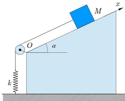
Un corps ponctuel  $M$  de masse  $m$  peut glisser sur un plan  $\overrightarrow{Ox}$  incliné d'un angle  $\alpha$  avec un coefficient de frottement cinétique  $\mu_c$ . Un ressort de constante  $k$  relie la masse  $m$  au moyen d'une corde sans masse au support horizontal. À l'instant initial, le ressort est à sa longueur de repos,  $M$  est au point  $O$  et une vitesse  $\vec{v}_0$  suivant  $\overrightarrow{Ox}$  lui est communiquée.
