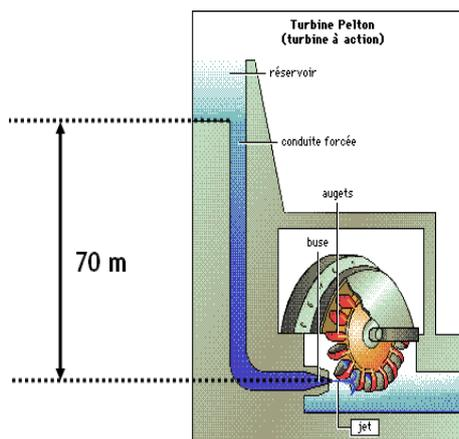
Une application importante de l'énergie potentielle gravitationnelle est le barrage hydroélectrique. On place une turbine sous le niveau d'un réservoir d'eau afin de transformer l'énergie potentielle de l'eau en énergie de mouvement capable de faire tourner la turbine qui produira de l'électricité. Quelle énergie, en kilojoules, peuvent fournir 10 l d'eau (1 l d'eau pèse 1 kg) dans une centrale électrique si la turbine est disposée 70 m sous le niveau du réservoir d'eau?
